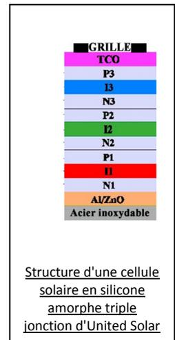
Grâce à cette structure unique de cellules et de modules, les produits United Solar Ovonic ne sont pas touchés par la corrosion TCO et il n'est pas nécessaire de mettre les modules à la terre en raccordant leur borne négative à la terre pour éviter leur détérioration. Remarque : la mise à la terre des modules peut être exigée par les codes de l'électricité applicables dans la région où le système est installé).
