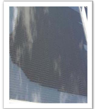
Les modules touchés par ce phénomène peuvent subir une importante perte de puissance au cours des premiers mois suivant l'installation. Contrairement à d'autres types de dégradation qui se produisent habituellement dans les modules à couches minces, la corrosion TCO provoque des dommages irréversibles et des pannes prématurées.
