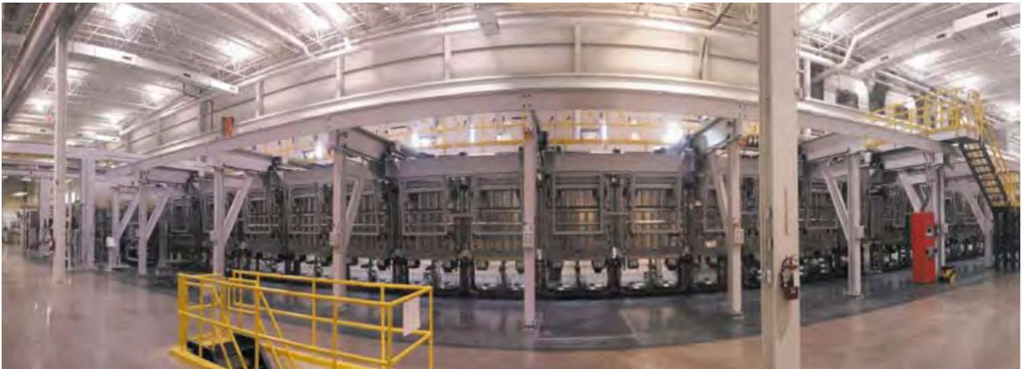
UNI-SOLAR-Dünnschicht-Solarzellen werden in einem Roll-to-Roll-Vakuumverfahren gefertigt und auf einen Edelstahlträger aufgebracht. Dieses Produktionsverfahren eignet sich hervorragend für die Fertigung hoher Stückzahlen.
