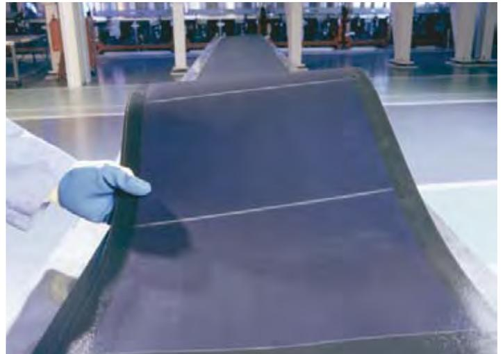
Das von der United Solar patentierte Roll-to-Roll-Herstellungsverfahren ermöglicht die Produktion für Massenmärkte.
