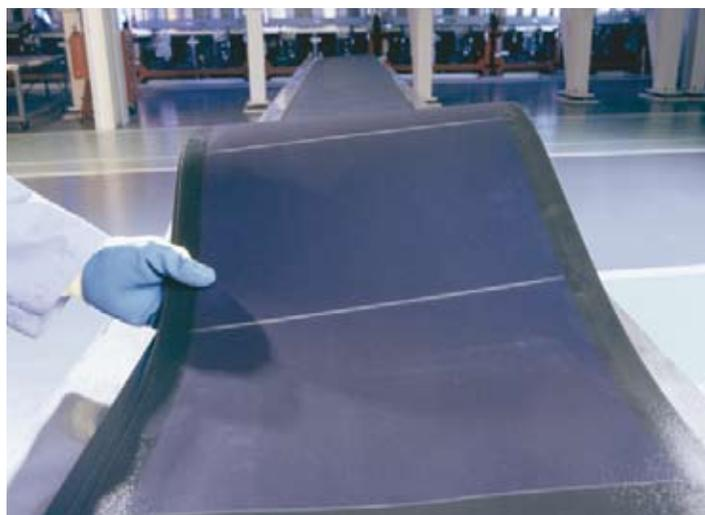
El proceso de fabricación "rollo a rollo" registrado de United Solar permite la fabricación en serie para los mercados de masas.
