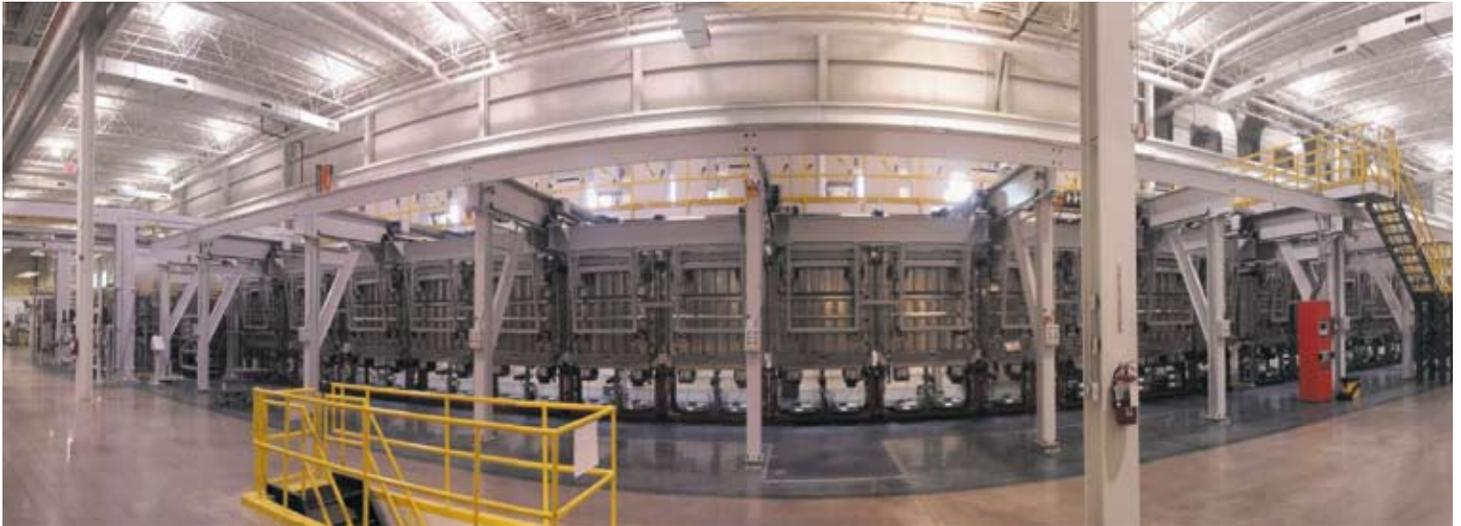
Las células solares de capa fina *UNI-SOLAR* se fabrican en un proceso de deposición en vacío rollo a rollo sobre un sustrato de acero inoxidable, excepcionalmente adecuado para la producción de grandes volúmenes.
