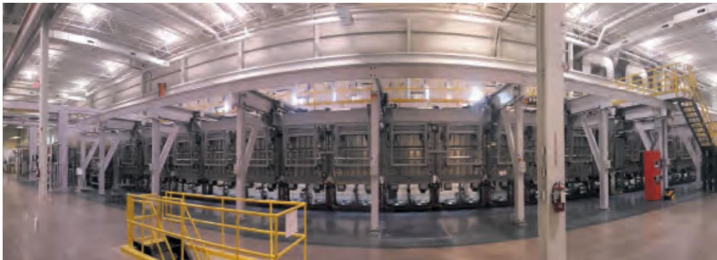
Les cellules solaires à couche mince *UNI-SOLAR* sont fabriquées à partir d'un procédé de dépôt sous vide avec un procédé *roll-to-roll* sur un substrat d'acier inoxydable, exceptionnellement adapté à la production en grande quantité.
