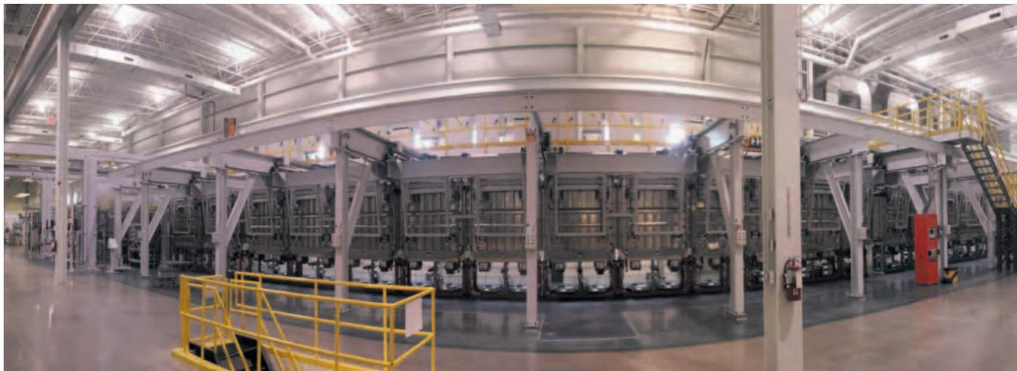
Le celle solari ultrasottili *UNI-SOLAR* sono realizzate mediante un processo di deposizione sotto vuoto roll to roll su un substrato di acciaio inossidabile, particolarmente idoneo a elevati volumi di produzione.
